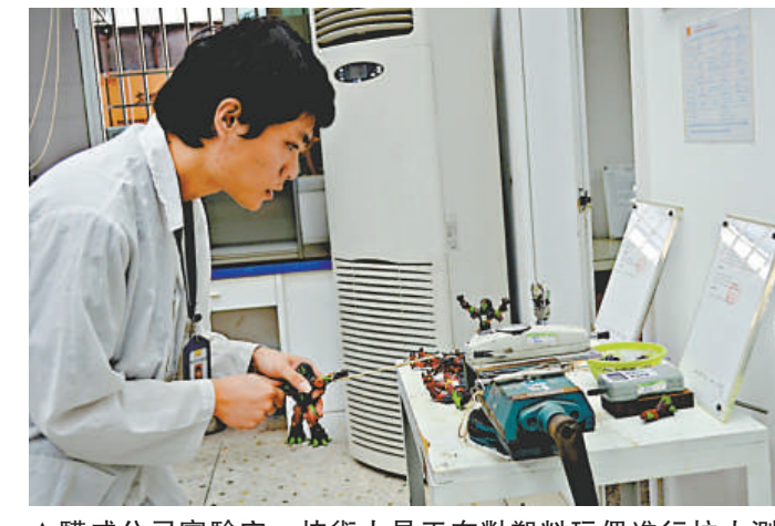
▲聯威公司實驗室，技術人員正在對塑料玩偶進行拉力測試 江雨馨攝
