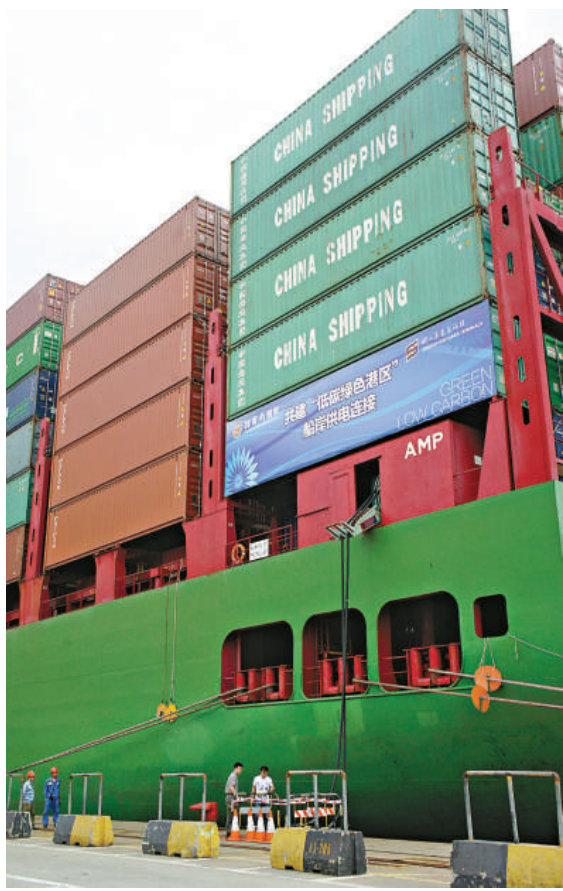
位於船側的船岸供電鏈接區
