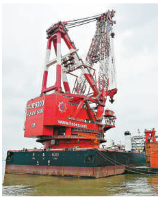
▲「華西5000」號最大額定起重重量高達4500噸，成爲亞洲單鉤起重能力最大的起重船
