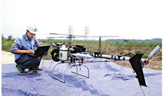
▲山東電力科學研究院人員正在調試無人直升機
