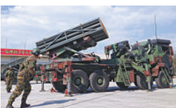
▲「雷霆2000」多管火箭系統擁有全自動化的車載射擊系統。圖為砲車聯合操作演練。 中央社
