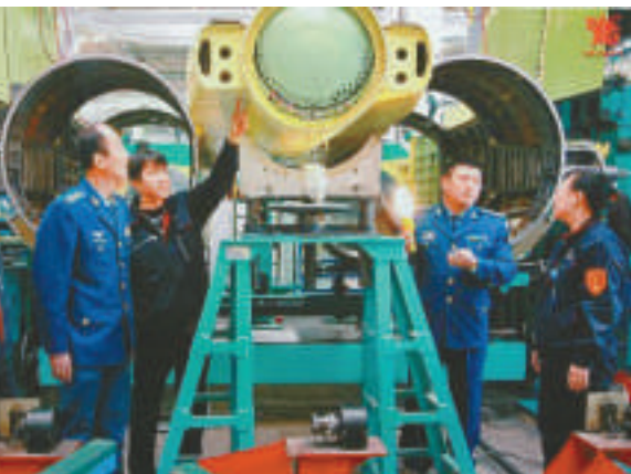
▲用3D打印的部件組裝戰機可減輕重量，令飛機在空中更靈活
