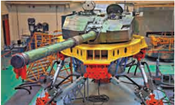
▲正在進行火控系統測試的99大改炮塔 網絡圖片
