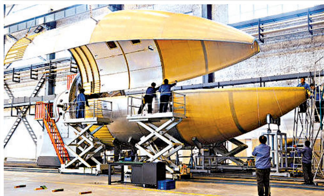
▲長征五號火箭首個整流罩成功下線，進行靜力試驗
