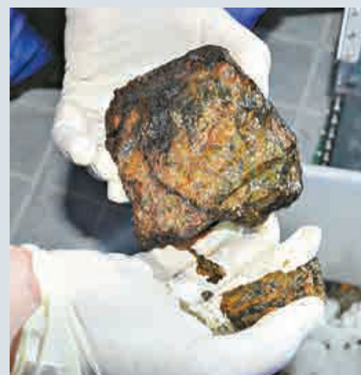
▲「蛟龍」號在西南印度洋採集到「煙囪」碎片，這是「蛟龍」號採集到的海底硫化物樣品 新華社 ▲26日，蛙人正在給「蛟龍」號載人潛水器掛纜 新華社
