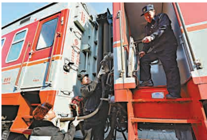
▶ 1月22日，天津動車客車段的職工對臨客車輛進行通信連接摘掛作業 新華社
