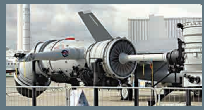
▲F35B的垂直升降動力方案能提供178千牛升力 資料圖片
