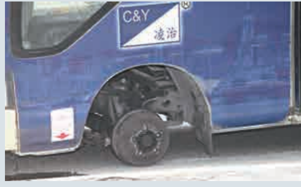
◀小巴輪軸五支螺絲均是齊口折斷，情況罕見
