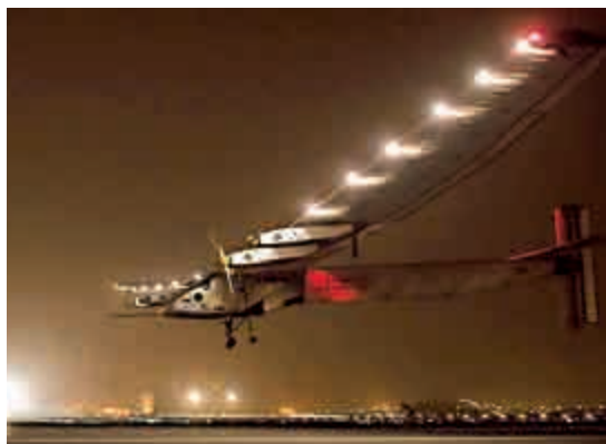
▲到了夜裡，「陽光動力2號」就得仰賴白天儲存的多餘電力飛行 資料圖片
