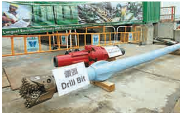
▲「水平定向鑽挖法」採用的鑽頭。本報記者麥潤田攝
