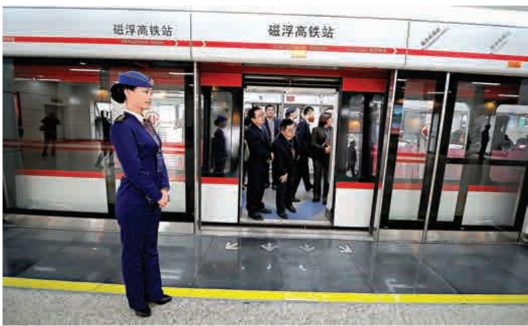
▲長沙磁浮高鐵路全長18.55公里，最高時速100公里，每列車可載客363人 中新社
