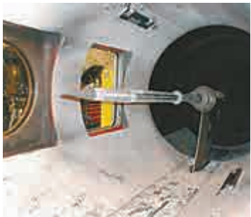
▲風洞可應用於導彈氣動效應研究 網絡圖片
