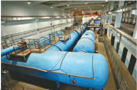
▲中國高超音速激波風洞可產生九馬赫風速 網絡圖片
