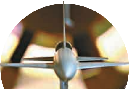
▲「JF-12」高超音速激波風洞能提供100毫秒實驗時間 資料圖片
