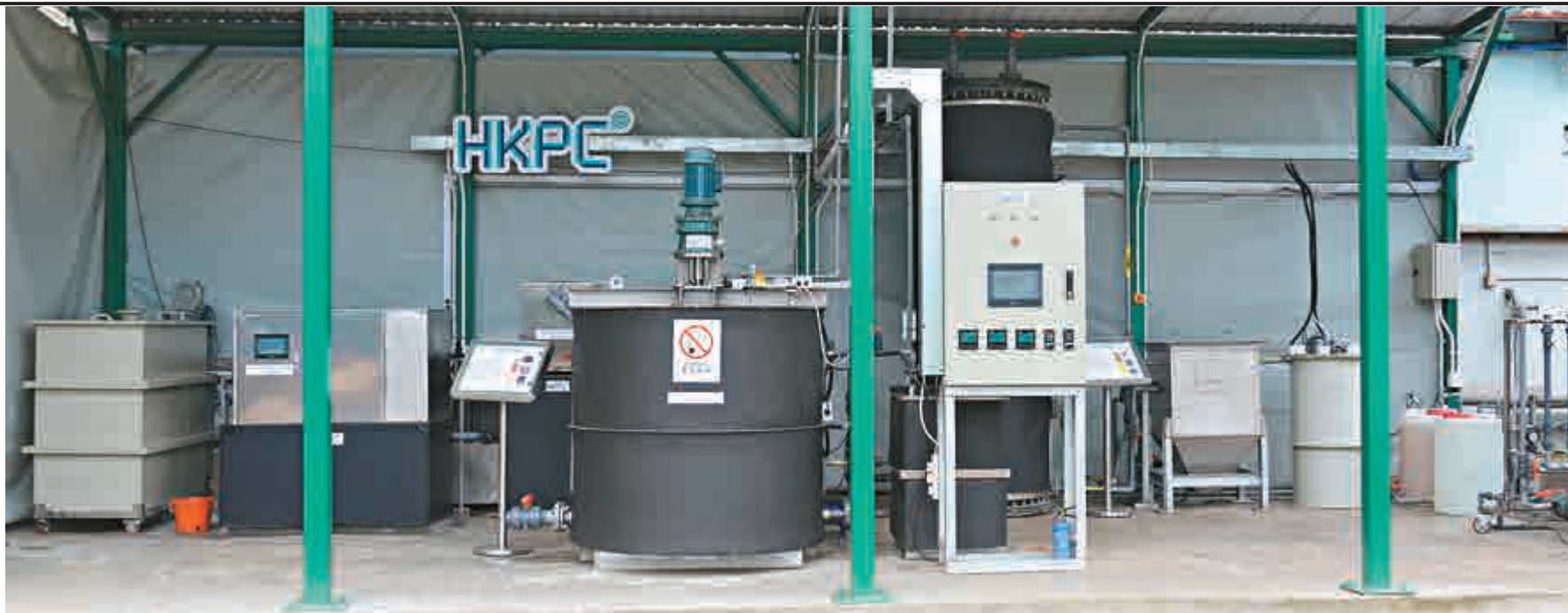
▲測試版的廚餘全面轉化系統外觀，左起廚餘收集箱（白色）、自動化廚餘前處理系統（銀黑箱）、分解有機物反應器（前方黑圓桶）、產甲烷生物反應器（後方高黑圓桶） 大公報記者梁康然攝
