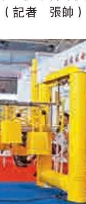
▲隨着波浪上上下下，波浪發電裝置可將波浪能轉化成電能 大公報記者張帥攝
