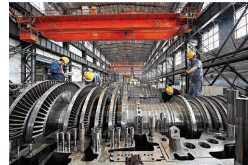
機濱 ◀「一帶一路」沿線國家用電需求日增，在哈爾濱，哈電國際工人按海外訂單要求製造汽輪機主 資料圖片
