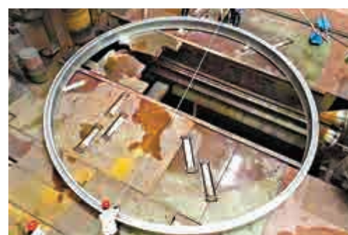
▲西南鋁工作人員正在檢測直徑10米級運載火箭鋁環。網絡圖片
