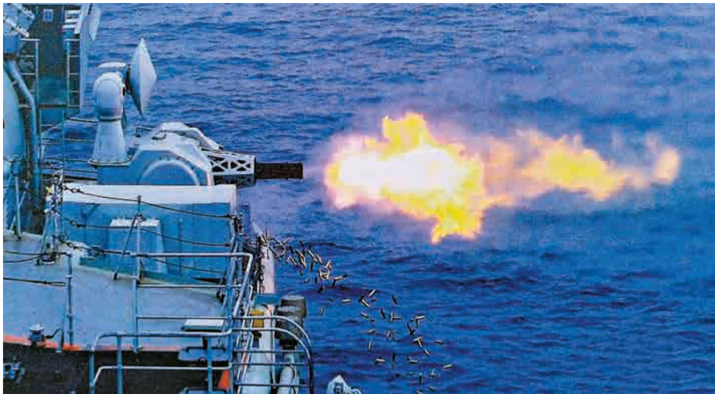
▲國產1130近防炮最大射速可達每分鐘10000發，火力猛烈
