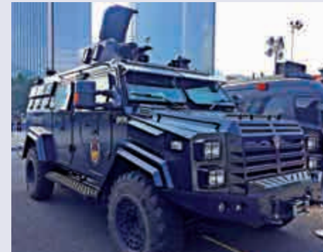
▲劍齒虎突擊車：速度130公里/小時，可防95式突擊步槍攻擊
