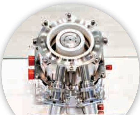
▲實踐十三號應用了自主研發的離子電推進系統。圖為中國研發的霍爾電推力器 網絡圖片
