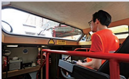
▲港鐵有三輛「軌道及架空電纜幾何紀錄車」，以鐳射掃描纜線的高度、移動幅度等 大公報記者林少權攝
