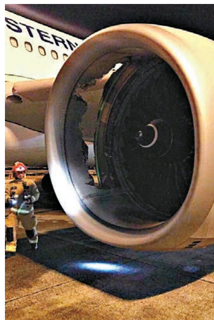
發生非包容性故障，碎片擊穿發動機外罩
