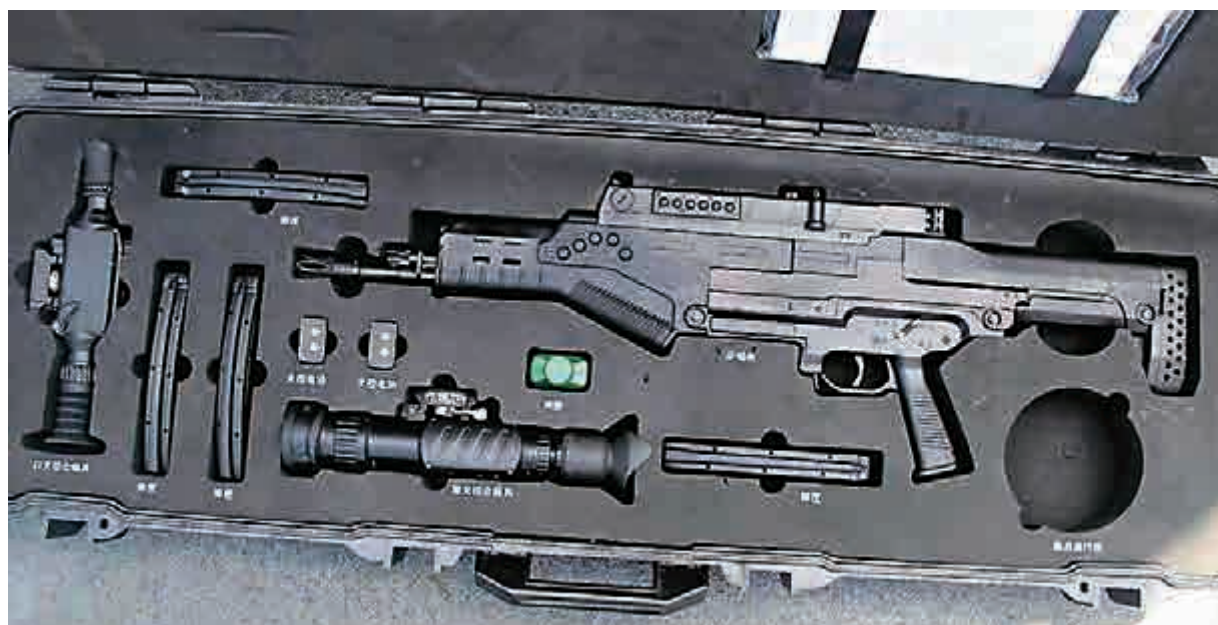
▲QTS11式單兵綜合作戰系統由計算機火控系統、光電觀瞄系統、智能榴彈發射器和步槍組成
