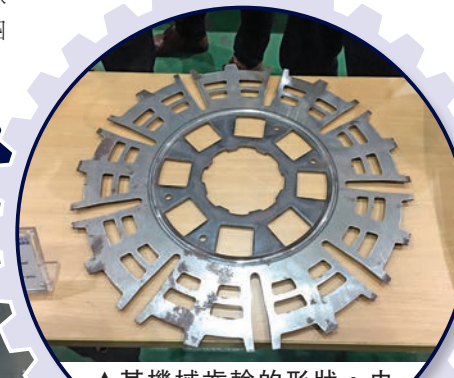
▲某機械齒輪的形狀，由激光設備打造成型
