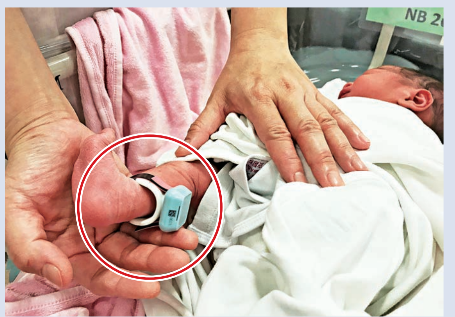
▲若有人剪斷腳帶（紅圈），系統在0.2秒內會發出警報 ▲系統總機設於護士站，屏幕顯示戴上腳環的嬰兒位置（綠色），若有嬰兒被帶離樓層，系統會發出警報和顯示最後出現的位置（紅色）
