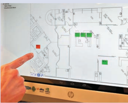
▲若有人剪斷腳帶（紅圈），系統在0.2秒內會發出警報 ▲系統總機設於護士站，屏幕顯示戴上腳環的嬰兒位置（綠色），若有嬰兒被帶離樓層，系統會發出警報和顯示最後出現的位置（紅色）
