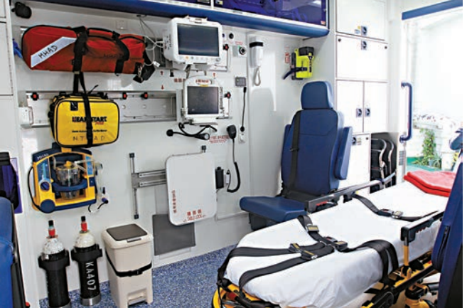
▲「黃車」的駕駛室與車廂完全分隔，增加儲存空間並能確保救護人員行車安全，而監察儀器的線路放在車頂，免阻礙拯救工作 大公報記者蔡文豪攝
