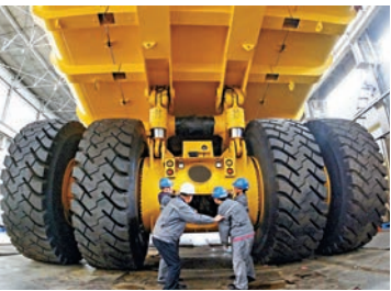
▲中車北京二七機車研發的雙燃料技術CR240E電傳動礦用自卸車投入考核階段 資料圖片
