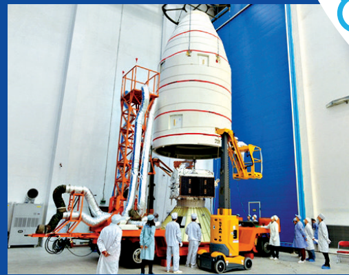
▲「悟空團隊」為衛星「悟空」進行扣罩 網絡圖片
