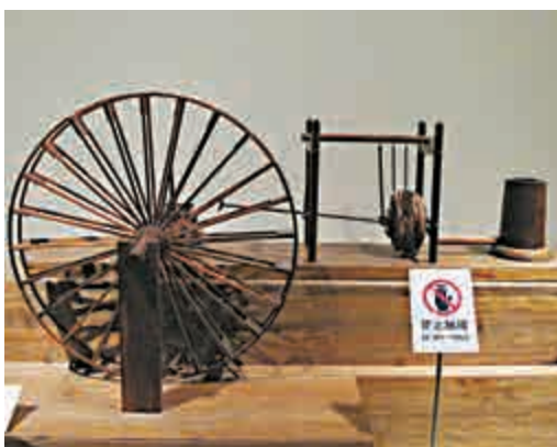
▲中國國家博物館展出，東漢金屬冶煉配套設施「水排」，利用水力鼓風，助燃爐火，提高金屬礦石化學還原水準
