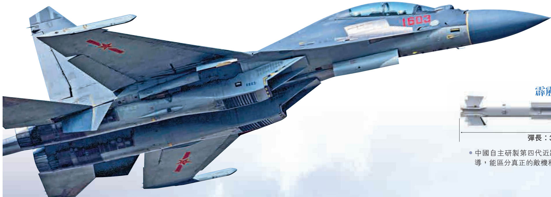
殲-16 ◀ 第四代多用途戰鬥機，具備遠距離超視距攻擊力和對地對海打擊能力
