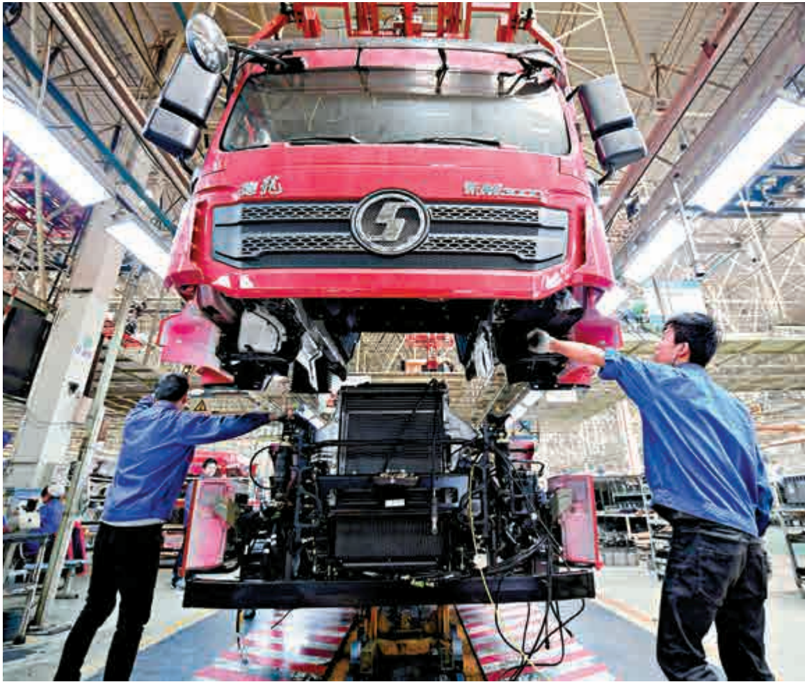
▲工人在陝重汽汽車總裝配廠車間內操作駕駛室吊具，將駕駛室與底盤進行連接 新華社
