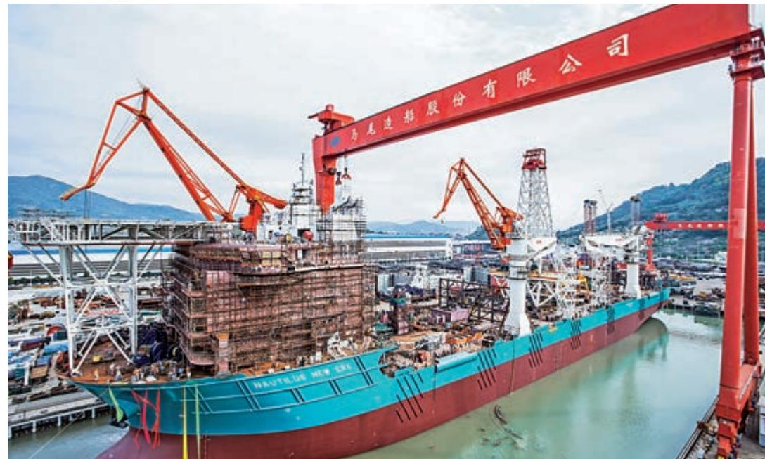
▲全球首製227米深海採礦船在福州市連江縣粗蘆島出塢下水，該船配置有全球首製的各類採礦系統，具備於2500米深海區域採礦作業的能力，可持續海上定位作業長達五年 中新社
