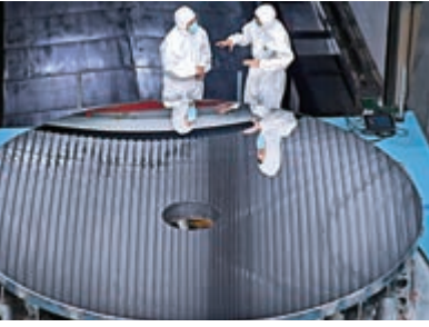
▲去年8月21日,探索9年、經18個月加工之「4米量級高精度碳化矽非球面反射鏡」在中科院位處長春的光學機械研究所通過項目驗收 資料圖片
