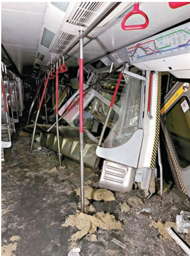
▲ 意外中車廂被撞至變形，滿地玻璃窗碎片，鋼管扭曲，閘門鬆脫
