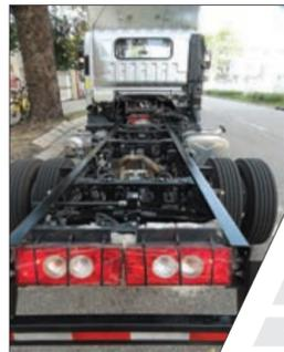
▲車陣採用精鋼製造
