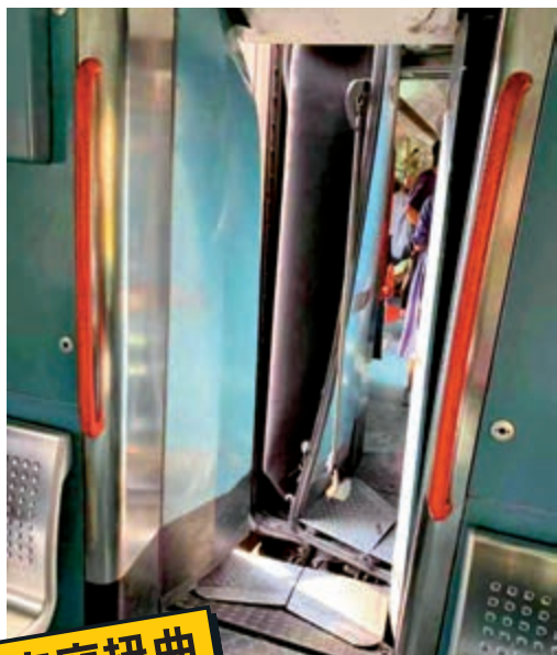
▲車廂內部嚴重損毀，接駁鐵片扭曲鬆脫
