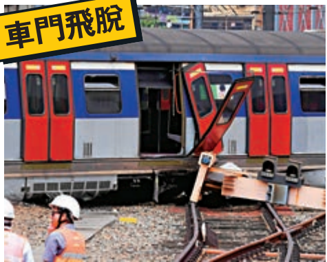
▲列車撞倒防撞欄車門飛脫，車底零件損毀 大公報記者林良堅攝
