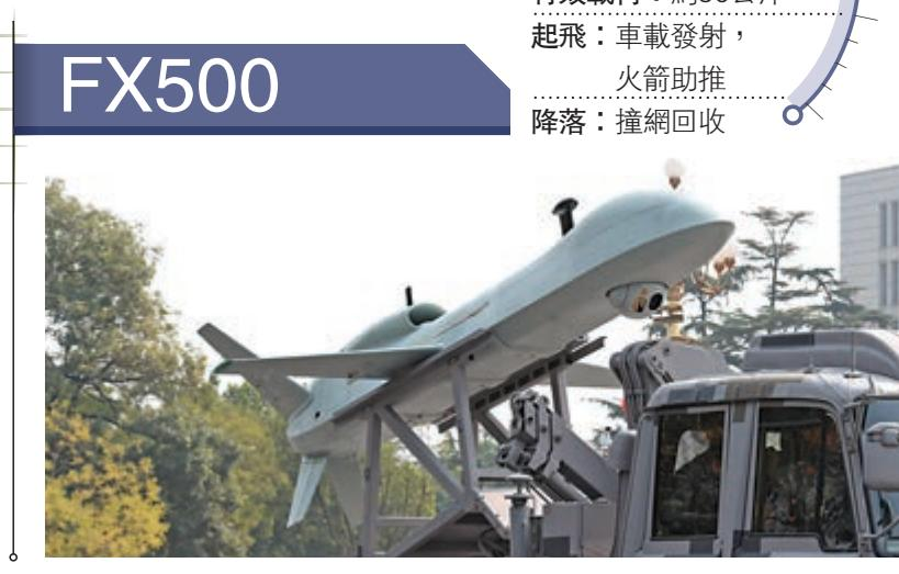
伴隨無人機亮相閱兵的，還有一款中程高速無人機FX500，是「銳鷹」系列無人機中體形最大的型號。時速最高可達800公里，續航2小時，飛行高度可達9000米，有效載荷約50公斤。
