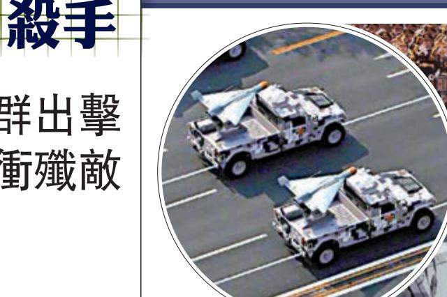
雷達是現代戰爭的「千里眼」，而反輻射無人機就是專門對付雷達的強大暗器。一旦摧毀了敵方雷達系統，就能夠掌握制敵權。反輻射無人機具備壓制敵預警探測和指揮通信系統的強大功能，能夠利用敵方雷達輻射的電磁波信號，進行探測、跟蹤，以至攻擊、摧毀雷達。
