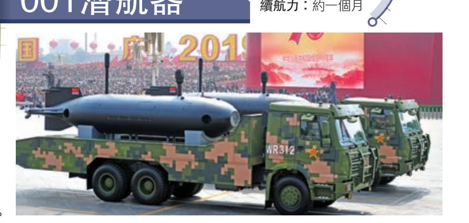
根據閱兵現場情況看，HSU001無人潛航器長約5米，直徑約1米，排水量應為3噸左右。仔細留意的話，不難發現其背部有可摺疊的光電桅杆和天線，用以探測和傳輸數據。相比於反潛飛機和反潛艦艇，直接在水下工作的無人潛航器，對於水下環境的偵測更為精確。
