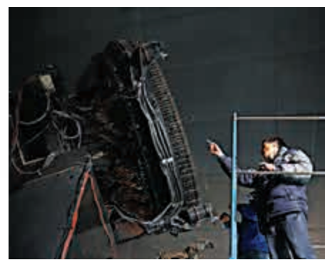
▲工作人員檢測郭守敬望遠鏡的焦面板 資料圖片
