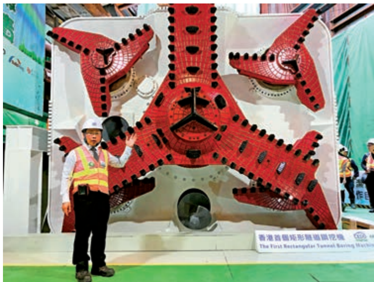
▲在地面造好的環狀預製組件將逐一吊入地底，配合鑽頭的鑽挖一環一環往前推進，形成隧道永久結構
