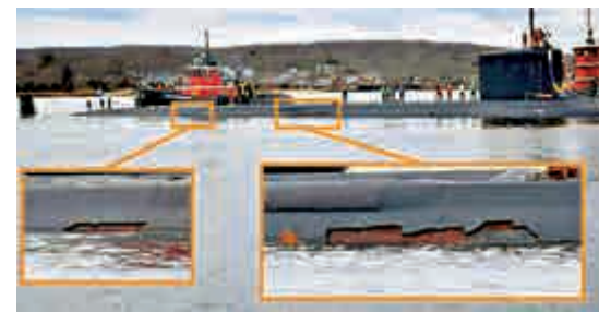
▲美國最新型攻擊核潛艇「科羅拉多」號被發現表面出現隱形材料的大面積脫落。網絡圖片
