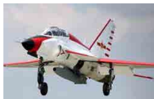
▲目前艦載機部隊的配套教練機教-9G可以完成陸地上滑躍起飛 資料圖片
