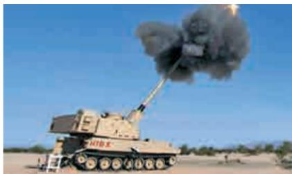
▲XM1299型自行榴彈炮裝有自動裝彈機，實際射速達到10發/分
