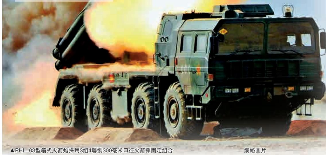
▲PHL-03型箱式火箭炮採用3組4聯裝300毫米口徑火箭彈固定組合
