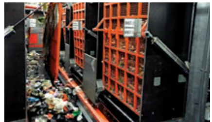
▲蘇伊士位於荷蘭鹿特丹的自動高科技分類中心，可以把塑膠包裝廢料分類，年處理量達十萬噸
