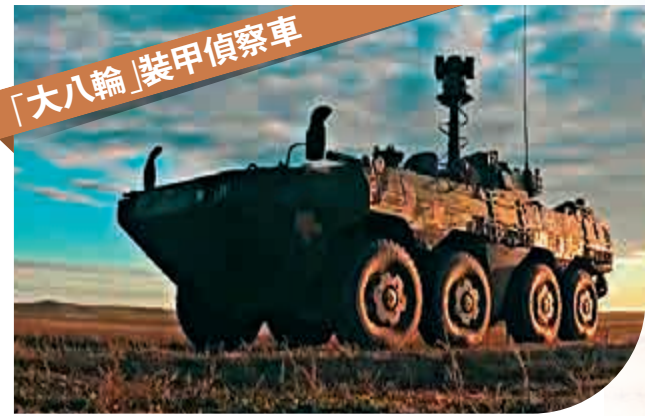
●該型偵察車內部空間寬敞，攜載有偵察無人機，車體炮塔後方有一個雷達／光電一體化偵察裝置的電子桅杆
