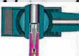
1 推彈機將埋頭彈推入右轉90度的彈腔
