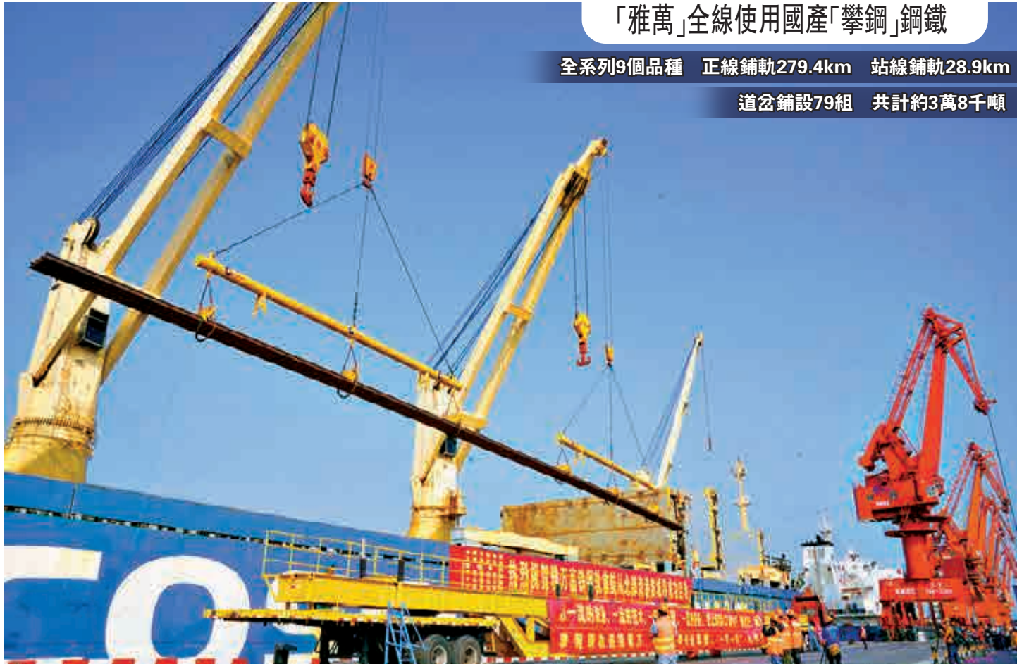
▲28日，中國高鐵整體出口首單——印尼雅萬高鐵路出海的第一批鋼軌在廣西防城港碼頭首航成功。圖為一根50米長的鋼軌被吊上郵輪 網絡圖片
