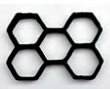
太空3D打印系統在軌打印的樣件
